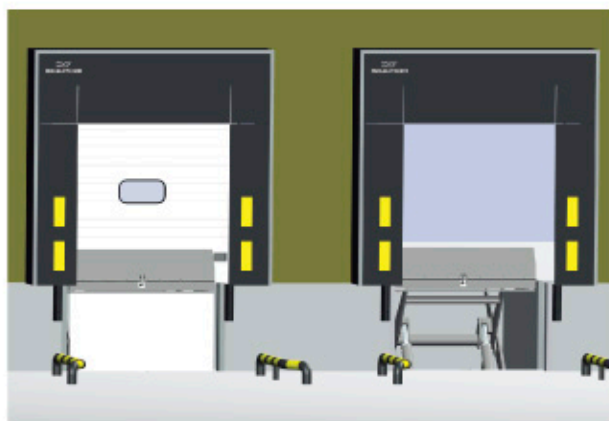
Quai de charge avec dénivelé.
