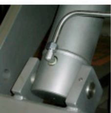
Vérin avec valve de sûreté incorporée
